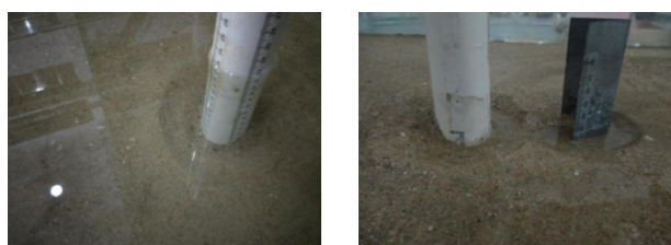
(a) Unprotected scour pit (d) Protected scour pit
